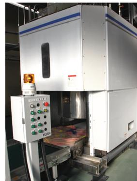
▲最終槽の水と品物を遠心脱水機 BRS-60 (左) と油圧脱水機 TAP-60H に搬送するウェットシャトルコンベア
