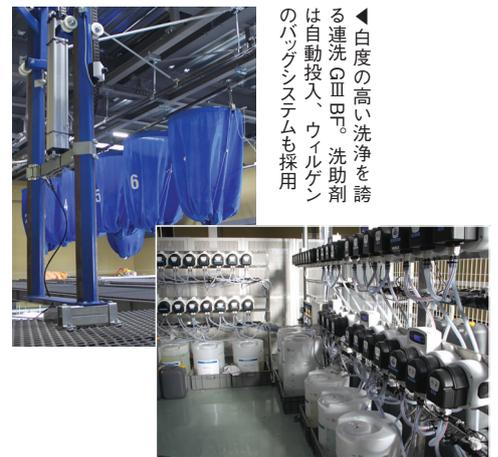
◀ 白度の高い洗浄を誇る連洗のⅢBF。洗助剤は自動投入、ウールゲンのバッグシステムも採用
