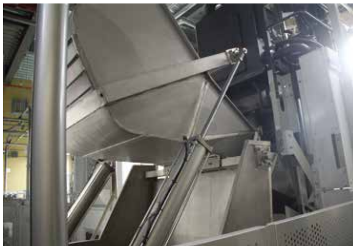
▲最終槽の水と品物を遠心脱水機・油圧脱水機へ搬送するウェットシャトルコンベア ▼BRS -60 (左) とTAP -60 H
