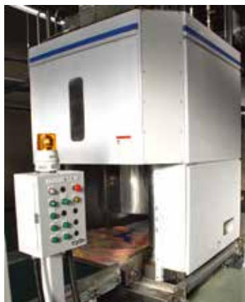
▲最終槽の水と品物を遠心脱水機・油圧脱水機へ搬送するウェットシャトルコンベア ▼BRS -60 (左) とTAP -60 H
