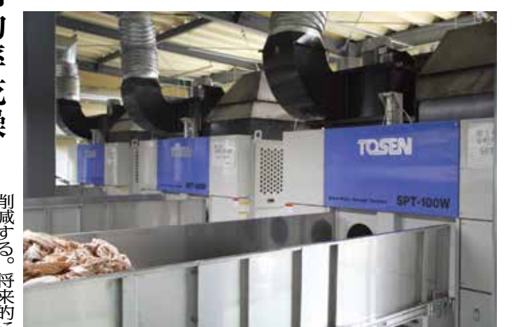
▲排熱再利用の省エネ乾燥機 SPT-100W
