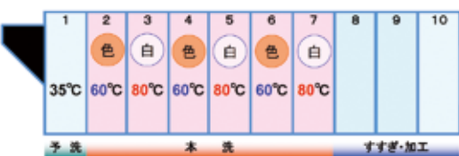
半永久的に独立槽を維持する構造。槽を分けるためにメンテナンスコストは、発生しません。
